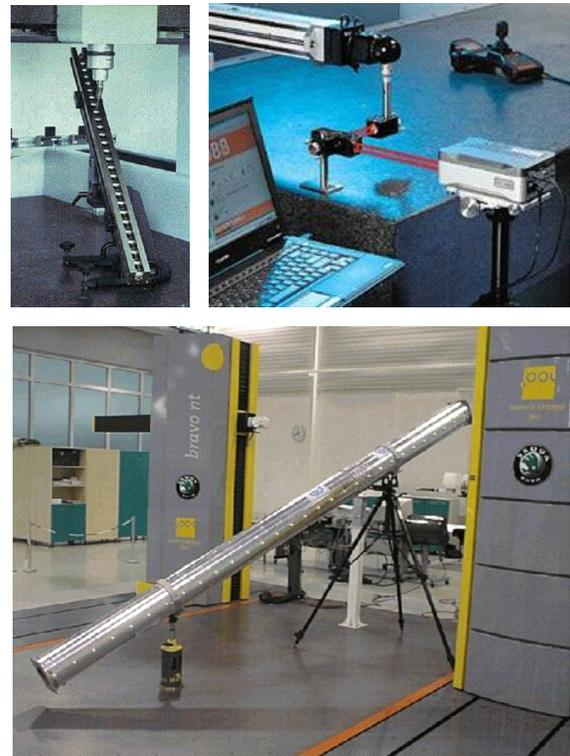
Fig. 4. Métodos usuais para avaliação da estabilidade geométrica de máquinas de medir por coordenadas de grande porte
